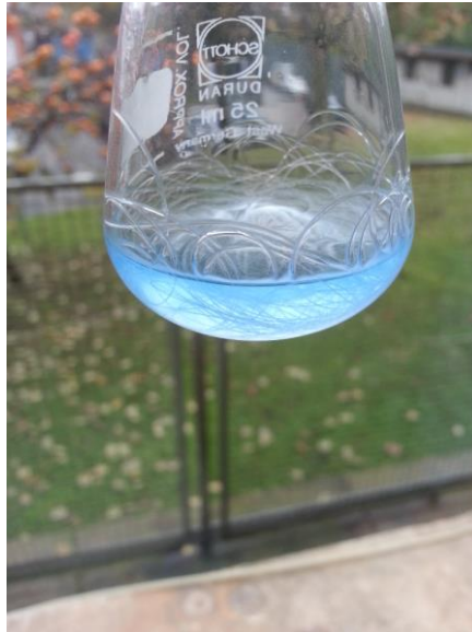
Nylon bollito in soda caustica per 30 minuti con aggiunta di solfato di rame
